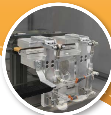
POSIZIONAMENTO, BLOCCO MATERIALE E TRASPORTO DEL MANICO
